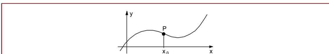
Figura 4.9.  $P$  é um ponto de inflexão do gráfico de  $f$ . Nesta ilustração, a curva  $y = f(x)$  é côncava para baixo antes de  $x_0$ , e côncava para cima depois de  $x_0$ .
