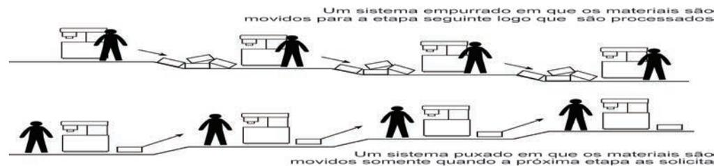
**Figura 22** Comparação dos estoques intermediários entre os sistemas empurrado e puxado.
