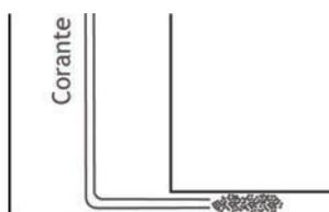
**Figura 1.21** Vazão alta. Uma corrente de tinta injetada num escoamento turbulento irá quebrar-se e se difundir por todo o campo do escoamento.
