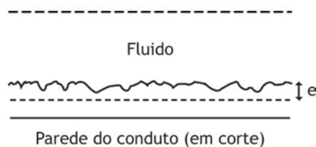
**Figura 8.4** Rugosidade da parede do conduto.
