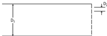
Figura 3.7 Tubo com um disco perfurado na extremidade final.
