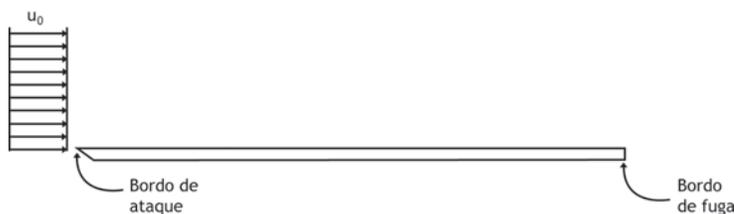
**Figura 6.1** Escoamento de um fluido com velocidade de aproximação uniforme  $u_0$  paralelamente a uma placa plana.
