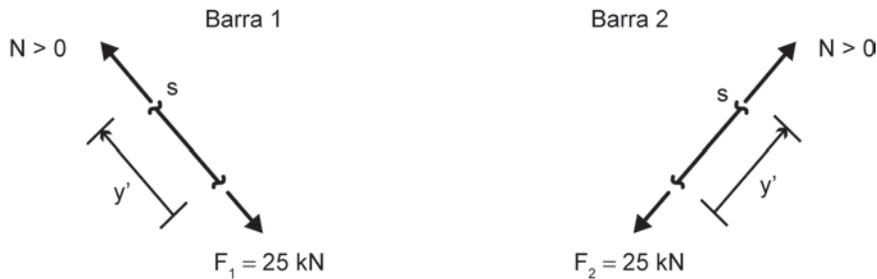
Figura 7.19 Esforços do corte imaginário nas barras deformáveis.
