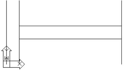
9. Vamos **fechar as quatro extremidades** do perfil, usando o comando LINE e o de precisão ENDPOINT.
