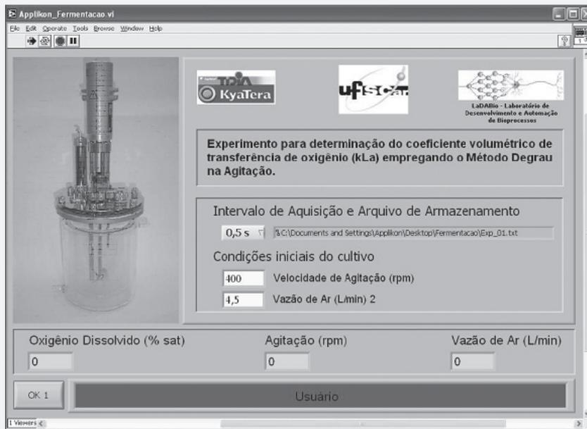
**Figura 16** Primeira tela do experimento de determinação de kLa pelo método degrau na velocidade de agitação.
